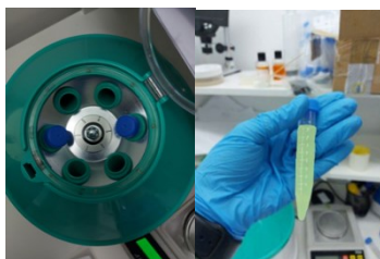
Рисунок 3 – Визначення колоїдної стабільності косметичного продукту
