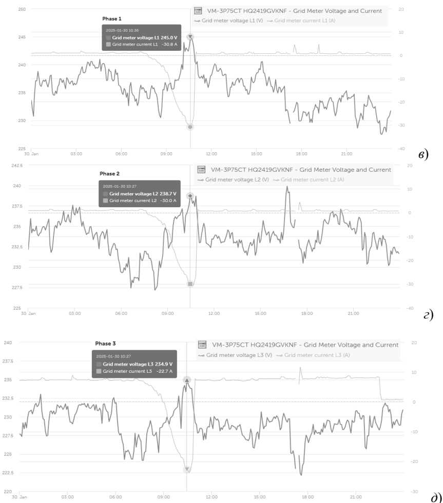
Рис.1. Багатоканалний моніторинг параметрів електромережі СЕС: а - генерація в мережу Fronius Symo (моніторинг solar web); б - генерація в мережу Fronius Symo (моніторинг VRM); в, з, д – фазні напруга та струм фаз відповідно L1, L2 та L3
