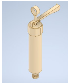
Рис. 1. Прототип упаковки-шприца для кондитерської пасти
