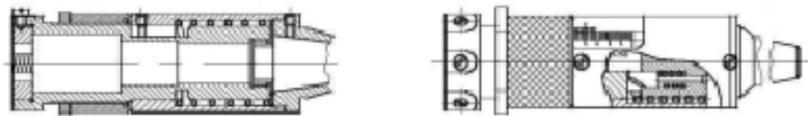
Рис. 1. Патрон для кріплення плашки на токарному верстаті
